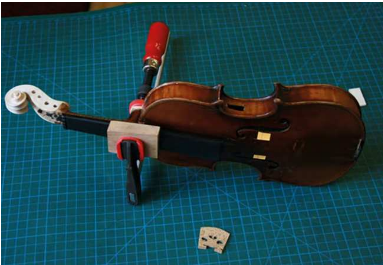
Klížení krku. Horní pražec je již na svém místě a plocha hmatníku začištěna.
