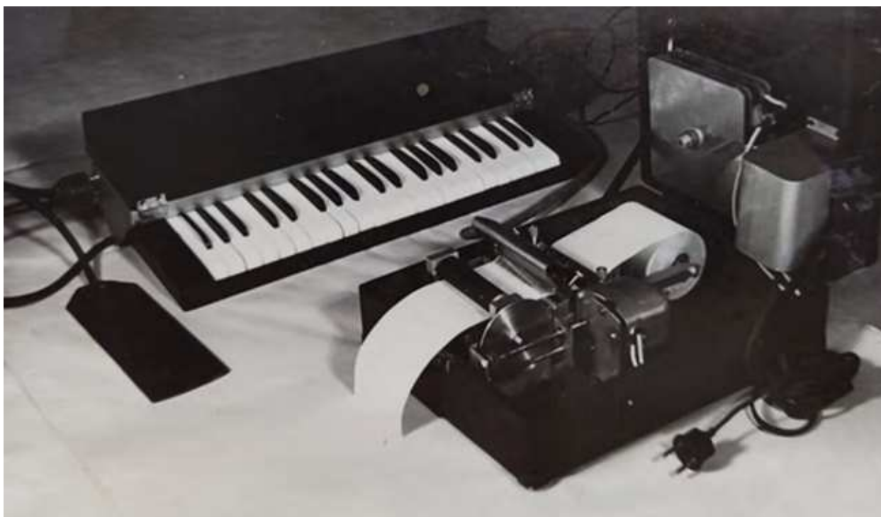
Pisací stroj, který samočinně zaznamenává hru na klavír nebo jiné klávesové nástroje. Ligmet, AP 758, Příhlášky vynálezů – patenty, inv. č. 52, č. ev. j. 165.
