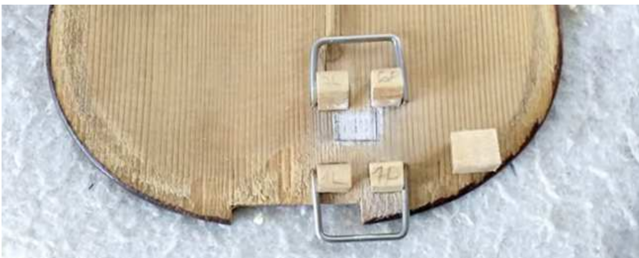
Prasklina ve spodní části horní desky byla sklížena a stažena pomocí patníčků a spon. Podleпка byla napasována a přiklížena ještě při stažených sponách.
