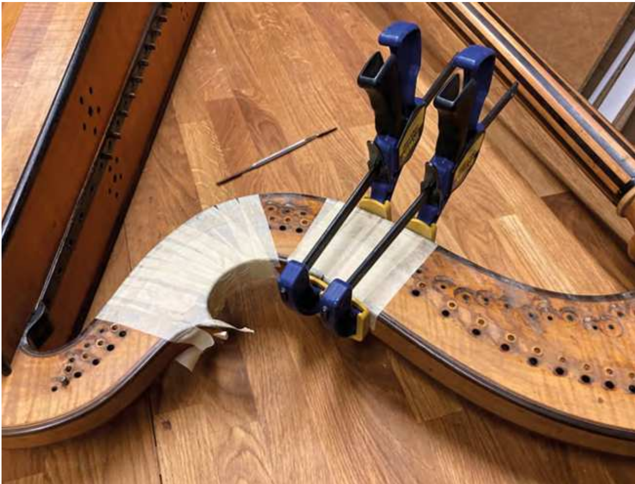
Průběh restaurování – detail: oprava ozdobného rámování krku.
